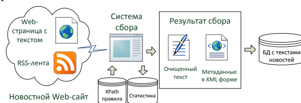
Рис. 1. Функционирование системы сбора.
